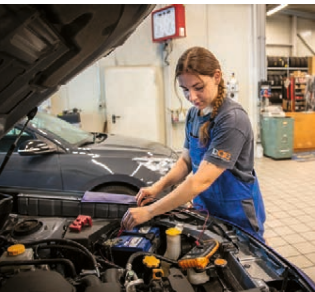
^ Con il multimetro, Sina misura la tensione elettrica.
